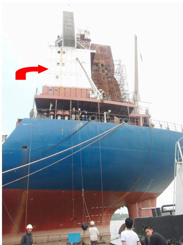
Hình. 7.1 Phần cabin là nơi NLĐ tiếp xúc với amiang khi phải bảo dưỡng tàu ( mũi tên chỉ)
